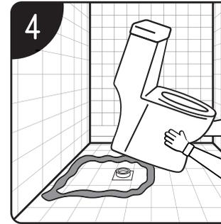
於地板畫出的輪廓線上及排污管周圍鋪上寬約3cm，高約1.5cm的水泥砂，水泥：砂比例為1:3，再將馬桶對準排污口安裝固定。
