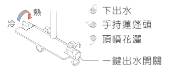
T8071 NEW 淋浴蓮蓬頭組 $21,200 顏色：鋼琴白 * 出水量固定 * 含溫度顯示器 * 手持蓮蓬頭為三段式出水
