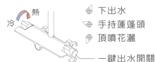
T9090 NEW 淋浴蓮蓬頭組 $22,800 顏色：紳士灰 * 出水量固定 * 含溫度顯示器 * 手持蓮蓬頭為三段式出水
