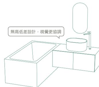
▶ 搭配加高型檯面臉盆，安裝檯面可下降至與浴缸高度平行，沒有段差的設計讓視覺更簡約俐落。
