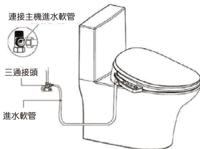
提醒：安裝時請勿扭曲、破壞進水軟管，否則可能引起漏水。
