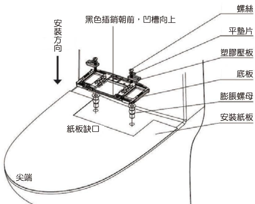
提醒：展開內附的安裝紙板，以尖端為準，與瓷器邊緣對齊後，平鋪在瓷器平面上，將底板安裝在紙板缺口上，底板與缺口對齊。
