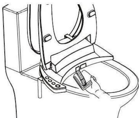
提醒：1. 清洗時不可拉扯噴桿，以免噴桿、主機損壞。
