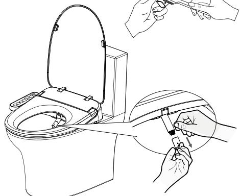
溫馨提示：請勿拉拽噴杆，以免損壞噴杆和電機。
