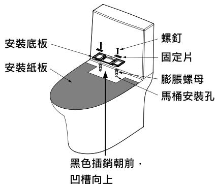
先將膨脹螺母裝入馬桶安裝孔內，再將底板、固定片、螺栓按圖示方向和順序裝在馬桶上並鎖緊。
