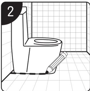
將馬桶與排污口對齊好後，試安裝於排污管上，沿著馬桶底部四周畫出外部輪廓線。
