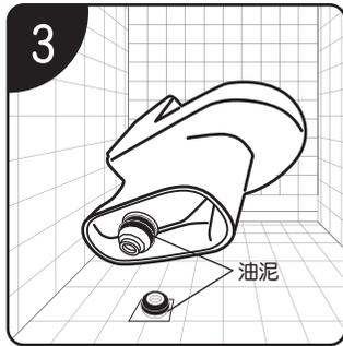
將馬桶輔助套管對準安裝於馬桶及地板排污口上，再將油泥安裝於馬桶排污套管下方及排汗管四周。然後安裝進水軟管於進水器上。
