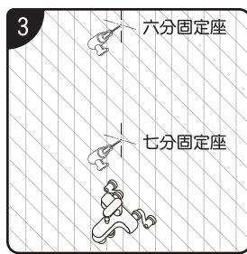
測定鑽孔位置後，於牆面鑽孔，鑽孔直徑7mm孔深35mm，然後安裝七分管專用固定座(下)及六分管專用固定座(上)。安裝完成後再將L型管及直管裝上固定座。
