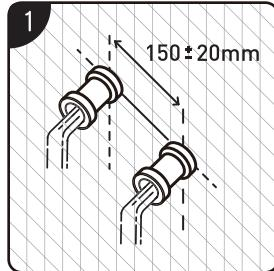
清除冷熱水管內雜質後，確認冷熱水邊位置，並安裝進水閥，然後把修飾蓋裝到進水閥上。進水閥應包覆止洩帶後，與水管連接，並旋轉到與牆面貼合。
