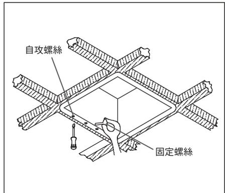
4. 在使用固定螺絲臨時地固定後，用自攻螺絲（4枚）牢固地固定。
