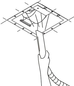
使用軟布沾上廚房用的清潔劑後擦掉風扇機體上的污垢，再用乾淨的軟布擦乾，重新裝上面板
