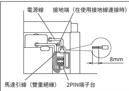
3. 將電源線接到2PIN的端子台上，
