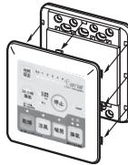
③ 觸控器電線的端子須準確插入觸控器背面的插座 (3P)。
