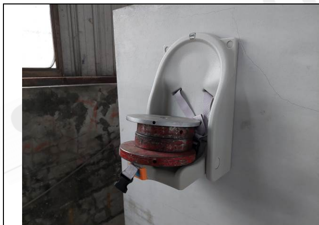
照片 E：測試架設-嬰兒安全座椅
