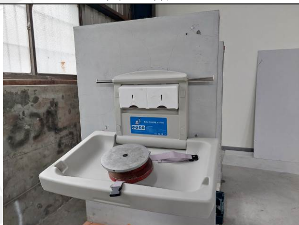
照片 F：測試架設-嬰兒尿布檯
